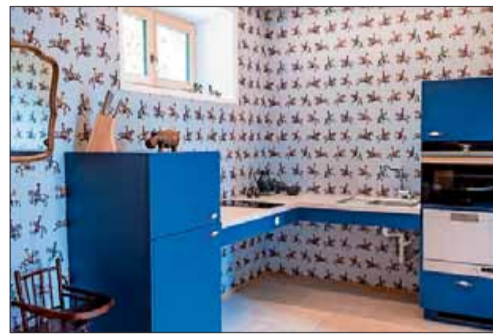
Die Küchen sind unterfahrbar, um Rollstuhlfahrern das Arbeiten zu erleichtern. M. Rahmann
